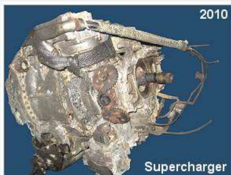
Spitfire-supercharger-motor-cook-mh907 collectie T. Schuurman en H. Roman (foto na opgraven)
